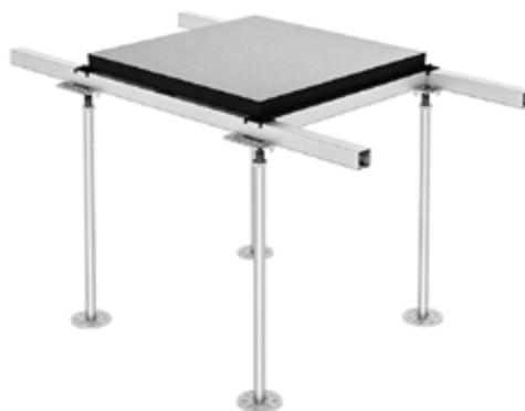
Sulla superficie inferiore, l'anima può essere rivestita in alluminio (sp. 0,05mm) o in lamiera zincata (sp. 0,4mm), al fine di aumentare la stabilità termo-igrometrica dell'intero pannello e di migliorarne le caratteristiche meccaniche. Le coperture impiegate sono in laminato HPL, vinile, linoleum o gomma, sia in versione antistatica che statico - dissipativa.
