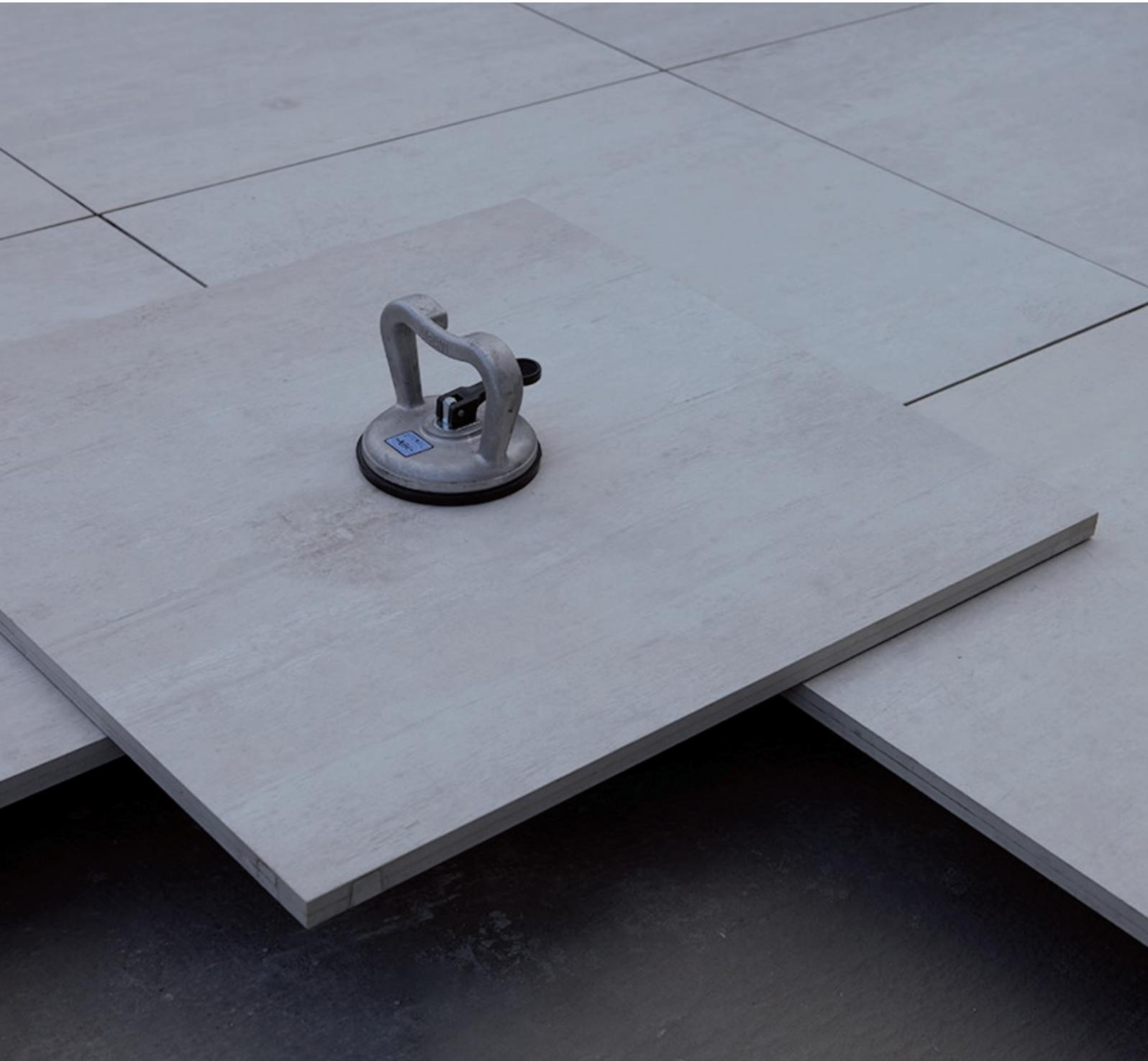
Twin Floor è un **pannello ad altissima densità** (Kg/mc 2.200), realizzato tramite un particolare processo di incollaggio della finitura superiore in gres o in materiale lapideo al supporto inferiore composto da materiali inerti ed inorganici, sinterizzati ad altissime temperature.
