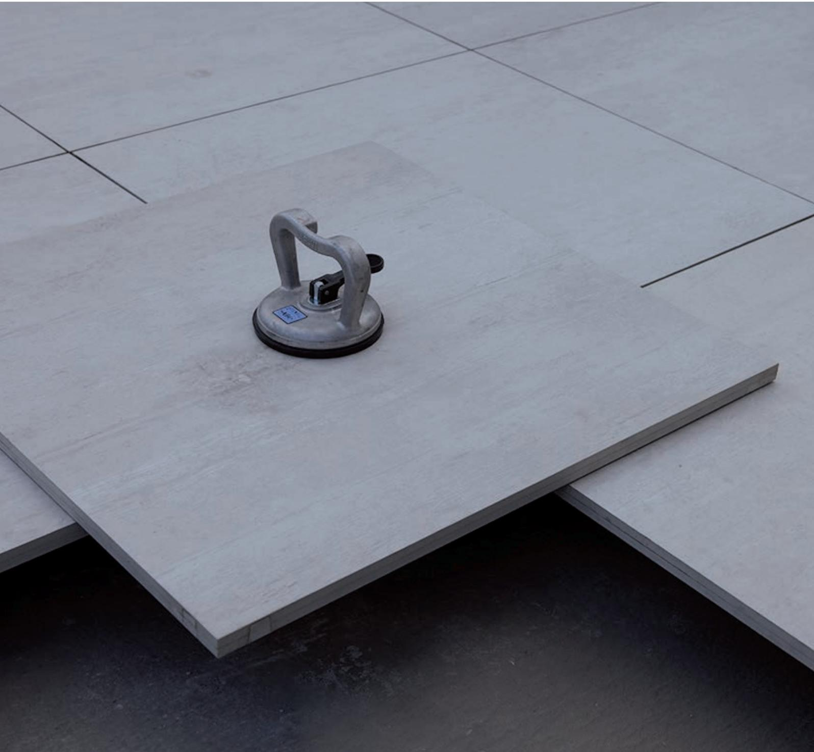
Twin Floor est un **panneau de très haute densité** (2.200 Kg/mc), réalisé par un processus de collage particulier de la finition des surfaces en grès ou en pierre sur le support inférieur composé de matériaux inertes et inorganiques, fritté à très haute température.
