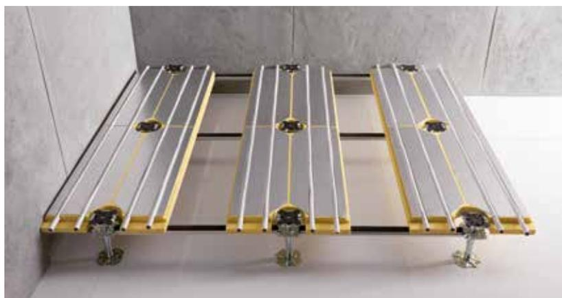
**5/** Posa dei pannelli radianti "neutri" in semplice appoggio a chiusura del plenum sottopavimento e completamento dello strato radiante.
